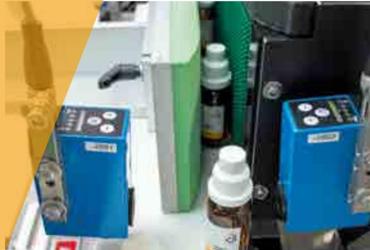
Sowohl das Kamerasystem als auch das Druckmodul sind im Touchpanel-HMI voll integriert und somit ebenfalls intuitiv bedienbar. Schieberegister im Spendegerät als auch in der kompletten Anlage machen das Produkt- und Labeltracking durch die komplette Anlage möglich.
