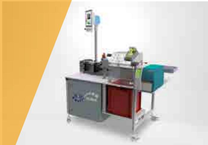
Sobald die Füllmenge pro Karton gemäß dem vorgegebenen Packschema erreicht ist, erzeugt das System automatisch ein serialisiertes Etikett für den Versandkarton. Es wird vom Bediener manuell aufgebracht und mittels Handscanner bestätigt, dass das Aggregationsetikett aufgebracht wurde. Abhängig von der Anzahl der Produkte im Versandkarton und der Anzahl der Aggregationsebenen können hier ca. 15 bis 20 Produkte/min serialisiert werden.
