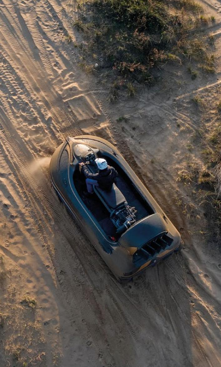
За счет принципа работы — перемещения посредством нагнетания воздуха под днище — Jetter подходит для эксплуатации практически на любом типе поверхностей, будь то водная гладь, болото, наледь, торосы, песок или снег. Подъемы и невысокие препятствия ему тоже по силам. А необычный вид судна точно не даст вам остаться в тени.
